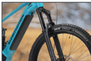
仕马圣定制前叉 36mm内管镁合金 140mm行程气压避震 带锁死阻尼可调
